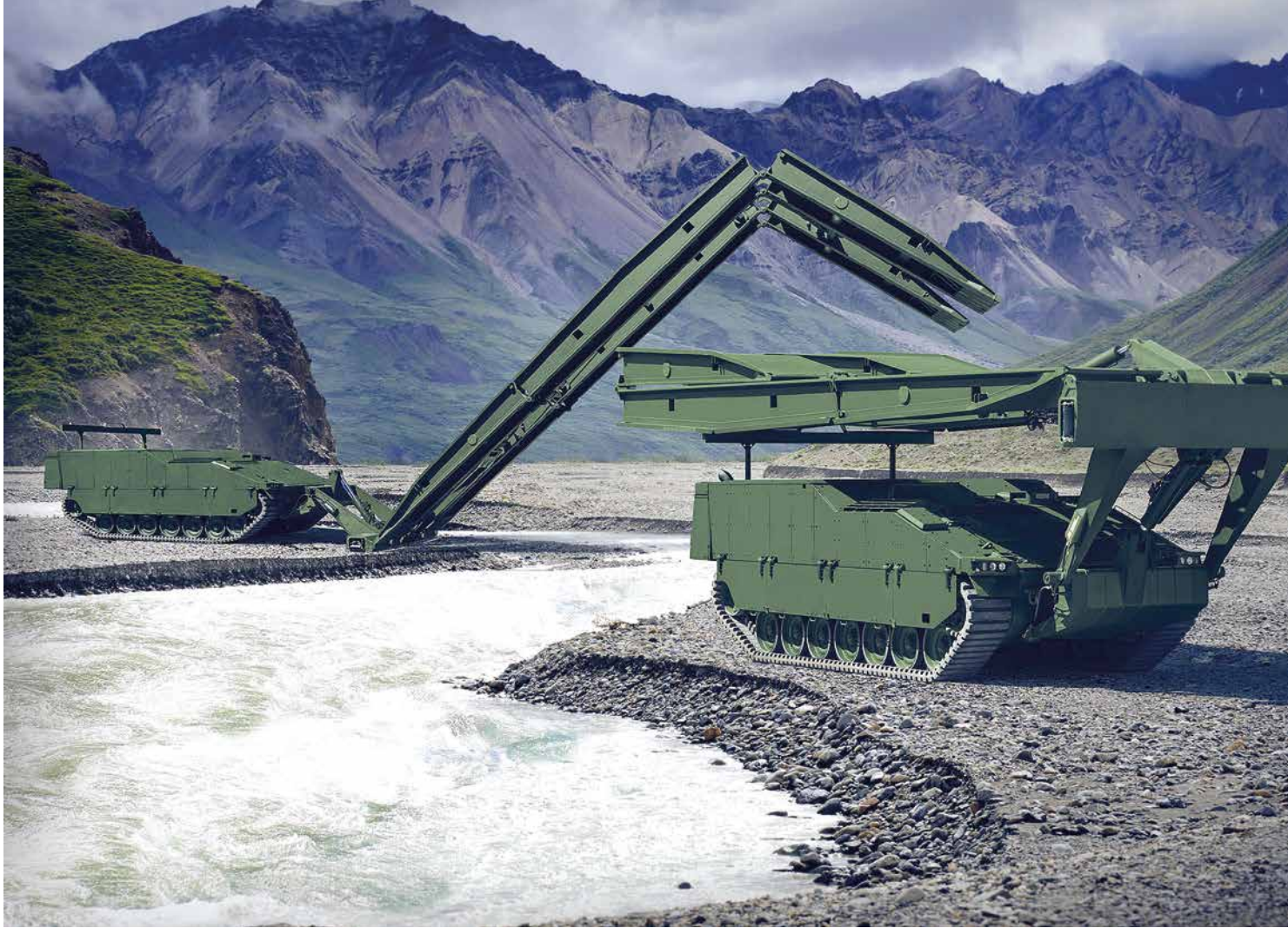
El ASCOD en su versión lanza puentes con un puente COBRA / @GDELS-SBS
