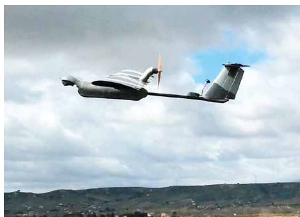
Sistema autónomo Seeker UAS, desarrollado por GMV y Aurea Avionics
