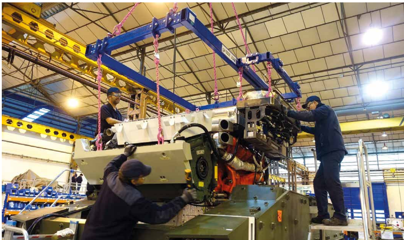
Montaje del grupo motopropulsor de más de 1.000 CV de potencia para vehículos de hasta 45 toneladas / @GDELS-SBS
