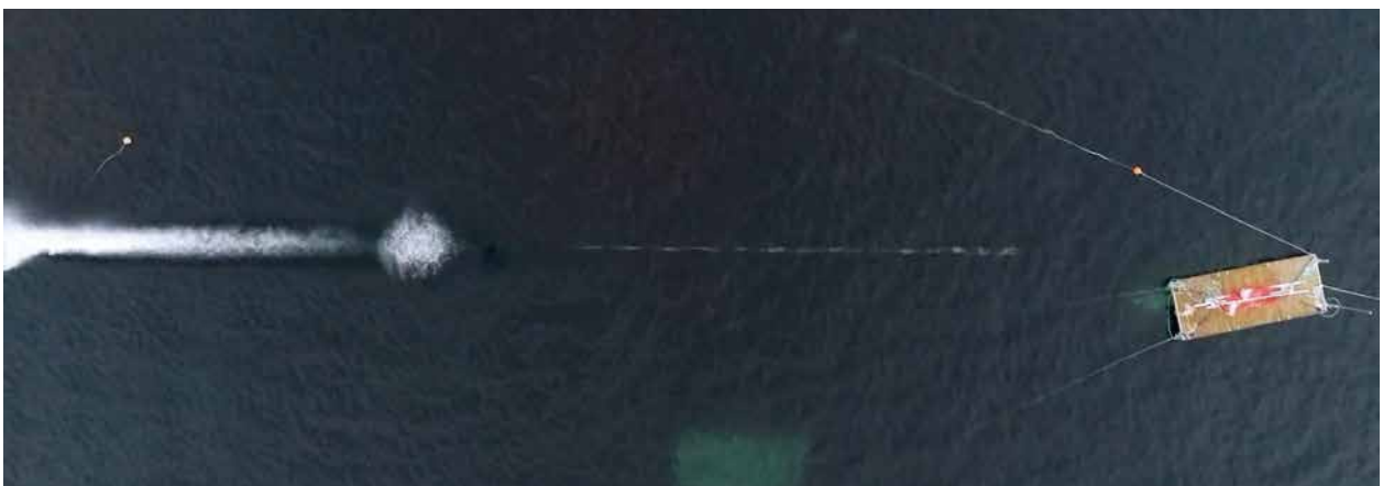
Demostración del proyectil 30 mm x 173 APFSDS-T mk258 mod. 1 manteniendo la trayectoria durante más de 100 metros dentro del agua
