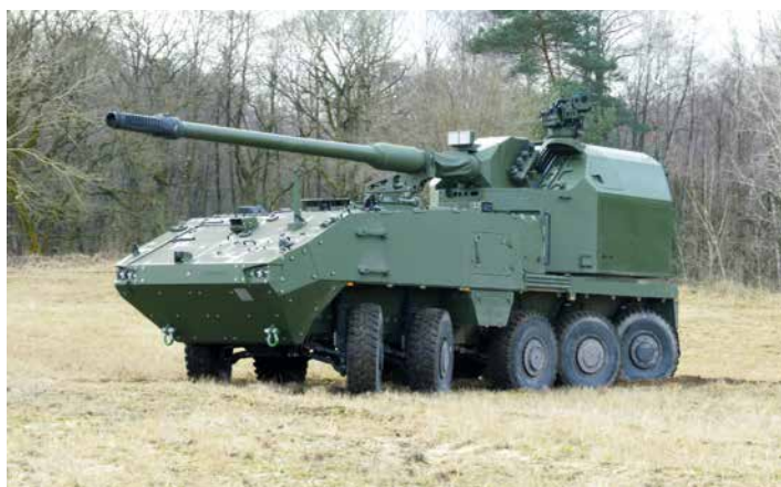
El vehículo blindado 8x8 Piraña en su versión de Artillería que incorpora el módulo AGM de 155m/L52 de la empresa KNDS / @GDELS-SBS
